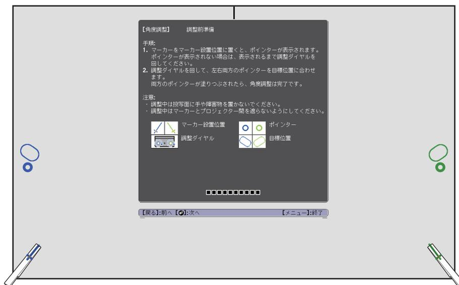
11 タッチユニットの調整ダイヤルを回して、左右のポインター（○）（○）が同じ色の目標位置（○）（○）に重なるように動かす
