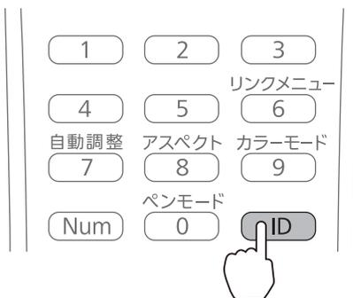
プロジェクターに設定されたIDが投写画面に表示されます。表示は約3秒後に消えます。
