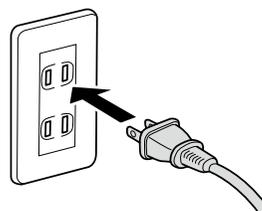
電源プラグは、コンピューター背面のサービスコンセントやスイッチ付きテーブルタップなどに接続せず、壁などに直付けされたコンセントに差し込んでください。
