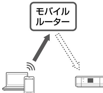
モバイルルーターに接続された機器間の通信が禁止されます。
