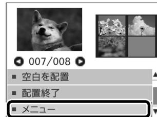
▲▼ ボタンで [メニュー] を選択して OK ボタンを押すと、写真の色補正やズーム印刷ができます。
