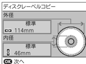
外径は 114 ~ 120mm まで、内径は 18 ~ 46mm まで 1mm 刻みで調整できます。設定した値は保存されないため、印刷の都度設定してください。
