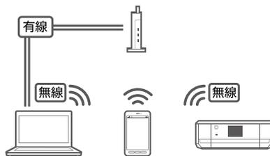
コンピューターやスマートフォンなどを接続している SSID が、プリンターと接続している SSID と一致している場合
