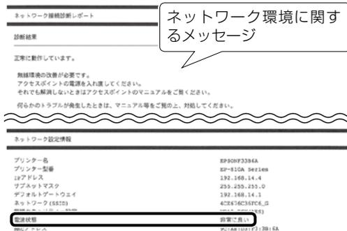
ネットワーク設定情報の電波状態が「弱い」や「悪い」と表示されているときは、アクセスポイントとプリンターの位置を見直し、お互いに見通せる、できるだけ近い位置に設置してください。
