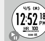
時計画面で START/STOP (⏸)を押すと、ランが選択され、GPS 測位が始まります。
