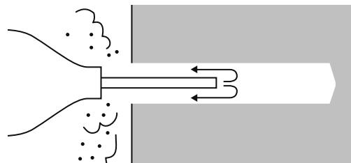
7 壁にウォールプレートを配置して、市販のM10×60mmアンカーボルトを穴に入れる
