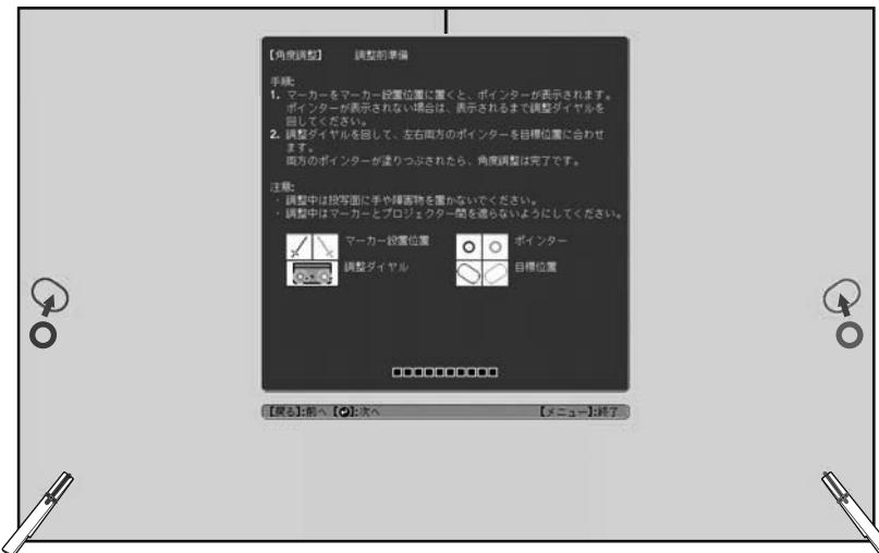
調整ダイヤルを反時計回りに回すと、ポインターが投写画面の外側へ向かって斜め下方向に移動します。
