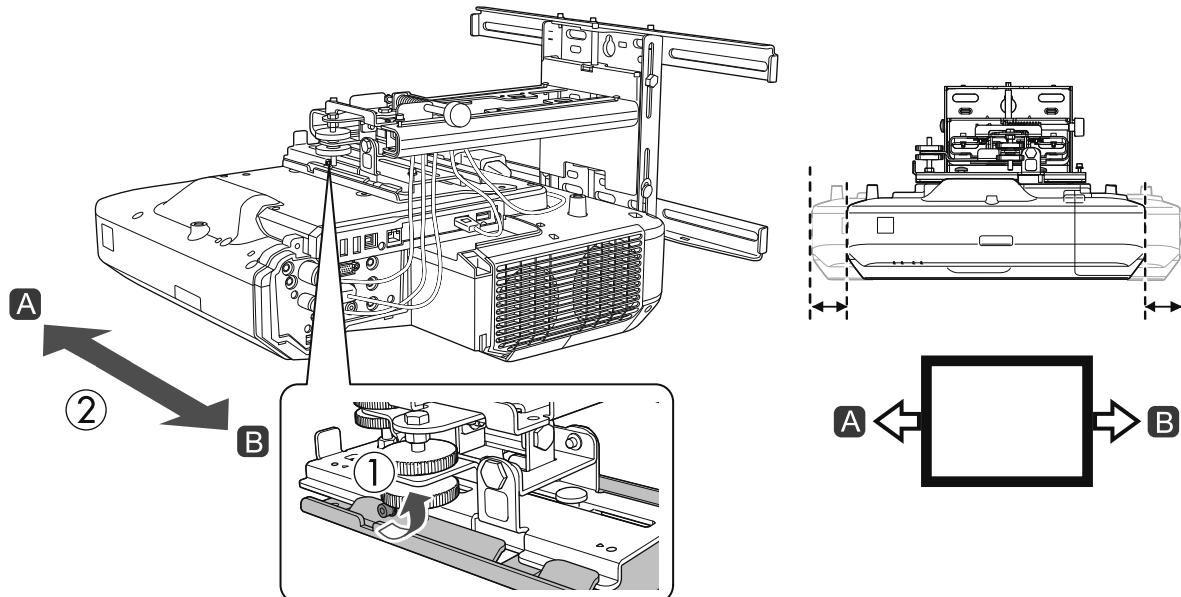
調整が終了したら、緩めたM4ボルトを締め直します。
