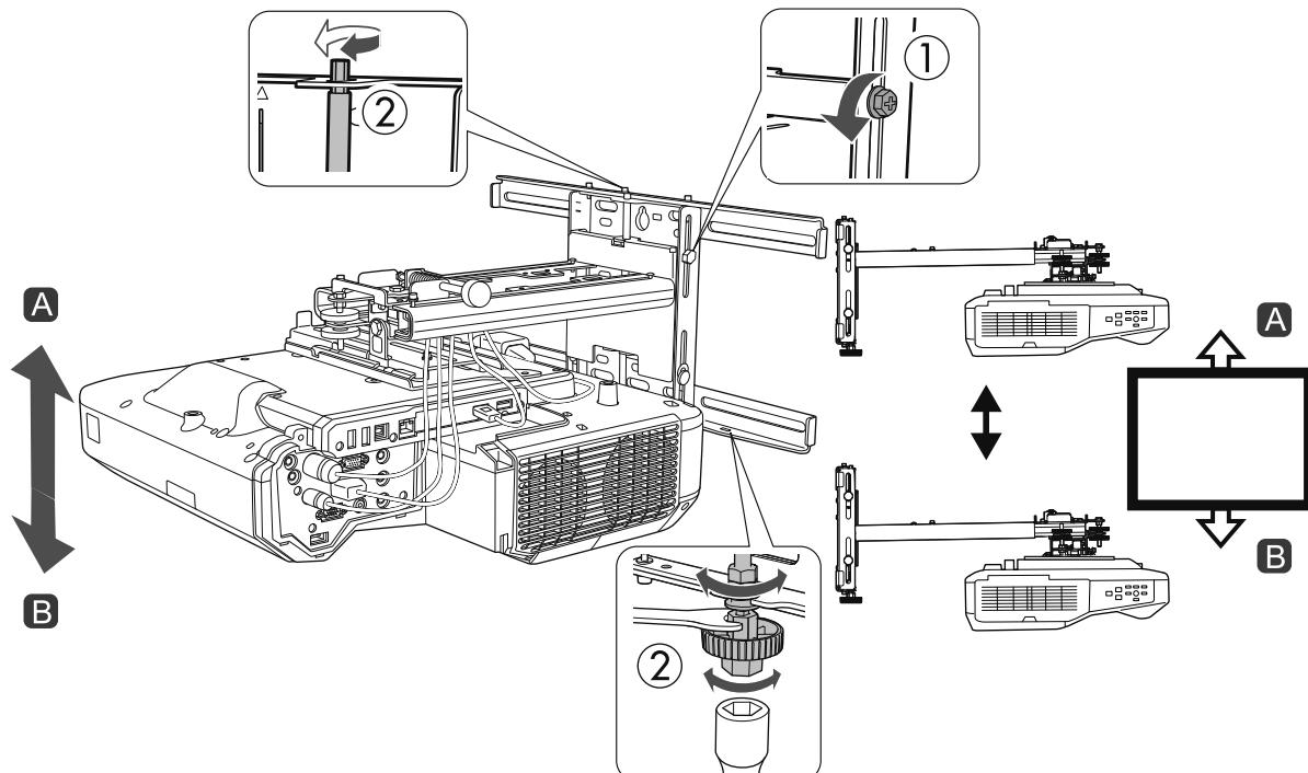
調整が終了したら、緩めたM6ボルトを締め直します。
