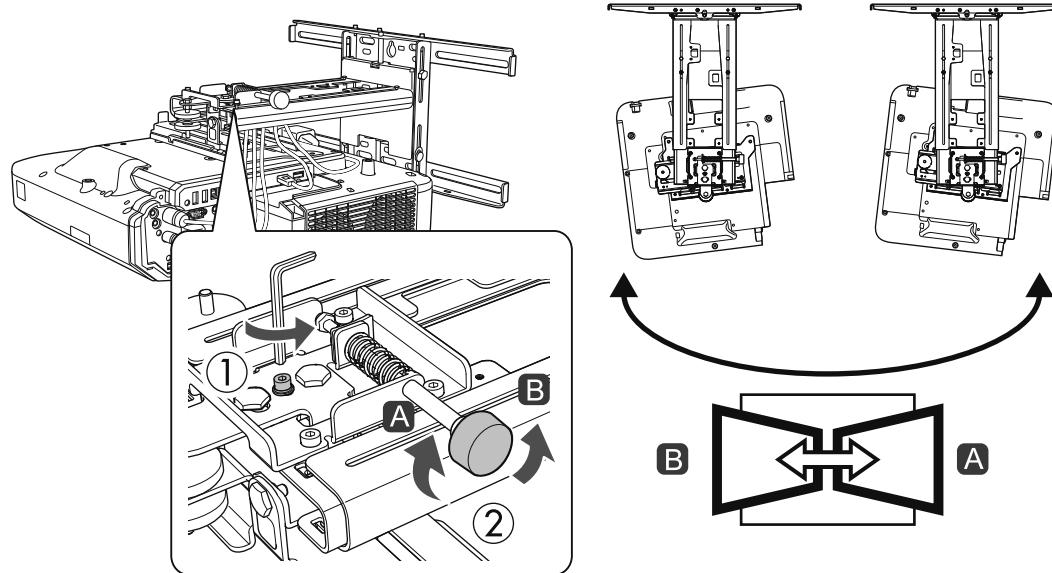
調整が終了したら、緩めたM4ネジを締め直します。
