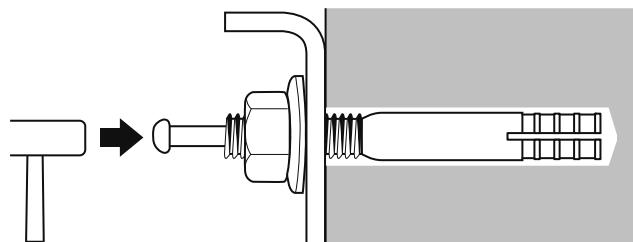
8 市販のスパナでナットを締めて、ウォールプレートを壁に固定する
