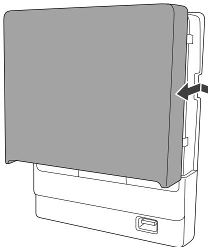
2 取り付け位置を確認して、市販のM4ネジ（20mm×4本）で固定する
