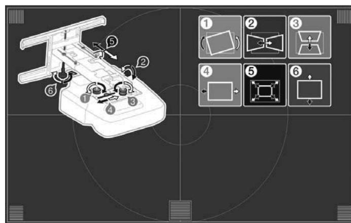
**6 下側の調整ダイヤルを緩めてから、上側の調整ダイヤルで水平ロールを調整する**
