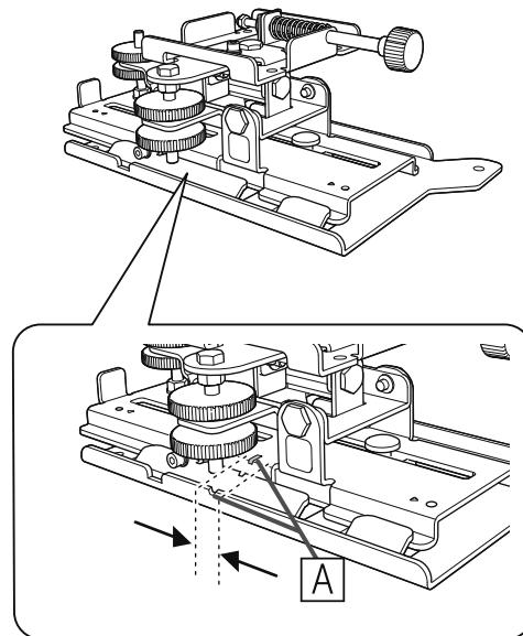
基準位置（A）が合っていないときは、M4ボルトを緩めてからスライドプレートの位置を調整します。調整が終わったら、ボルトを締め直します。
