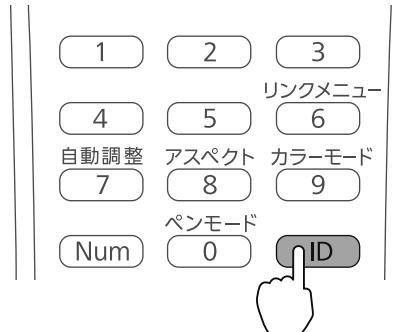
プロジェクターに設定されたIDが投写画面に表示されます。表示は約3秒後に消えます。
