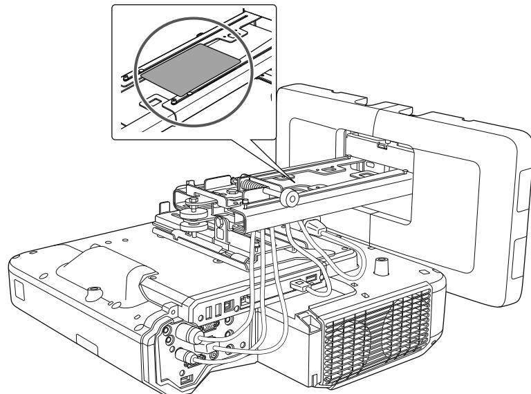
3 プロジェクターにケーブルカバーを取り付けて、ネジ（2本）で固定する
