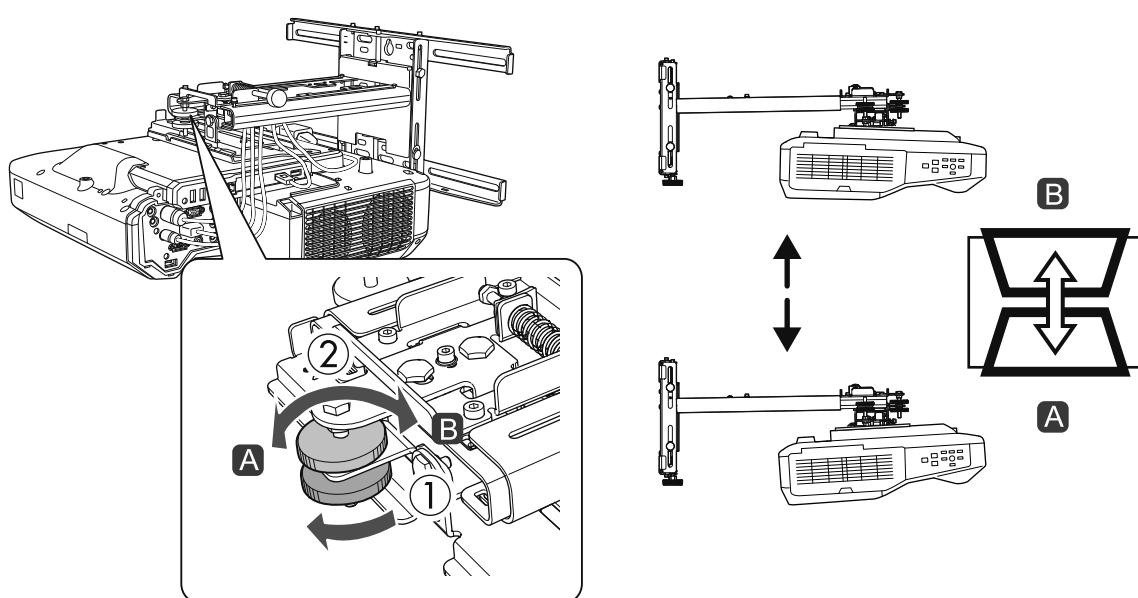
調整が終了したら、下側の調整ダイヤルを締め直します。
