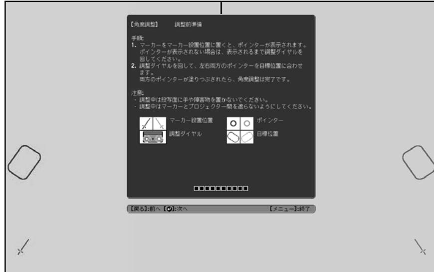
**8 投写画面のマーカー設置位置 (×) (×) に、同梱のマーカー2個を重ねて固定する**
