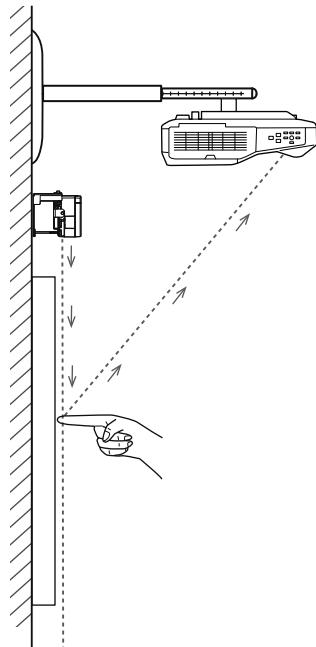
プロジェクターが指の位置を正しく検出できるように、タッチユニットから照射されるレーザーの角度を調整します。
