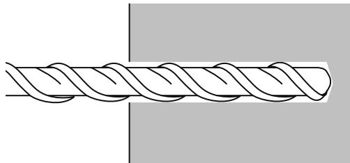
6 テンプレートシートを取り外し、ダストポンプなどで穴の中のコンクリート粉を取り除く
