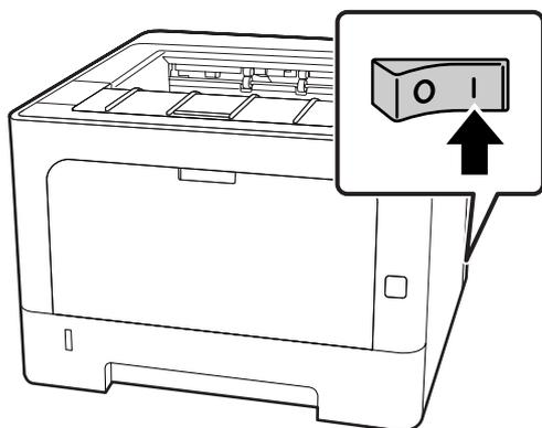
トナーの充填が始まり、操作パネルに「トナー充填中」と表示されます（用紙がセットされている場合）。トナー充填が終了するまで（約7分）電源を切らないでください。
