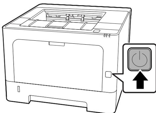
充填中は全てのランプが点灯と消灯を繰り返します。充填が終わるまで(約7分)そのままお待ちください。充填が始まらないときは、トナーカートリッジが正しくセットされているか確認してください。
