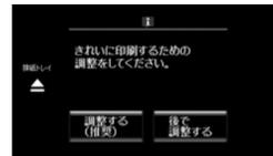
[調整する (推奨)] を選択し、プリントヘッドのノズルチェック、印刷ずれ調整としてプリントヘッドの調整・紙送り調整を順に行います。調整には A4 普通紙の印刷用紙が必要です。画面に用紙をセットする指示が表示されたら、以下の手順に従って用紙をセットしてください。
