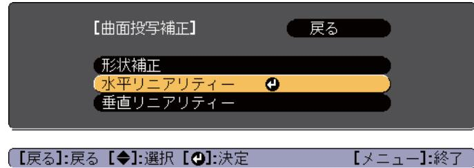
左右方向の伸縮を補正する場合は【水平リニアリティ】、上下方向の伸縮を補正する場合は、【垂直リニアリティ】を選択します。
