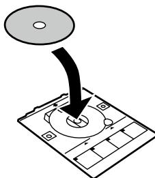
**7** ディスクトレイをプリンターに挿入します。プリンター側とトレイ側の三角マークを合わせてください。
