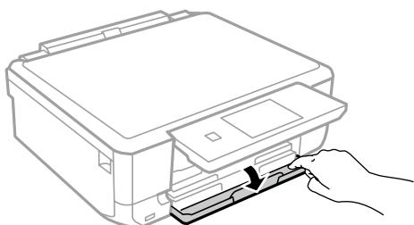
3 プリンターが動作していないことを確認して、上トレイを引き抜きます。上トレイには目印▶が付いています。
