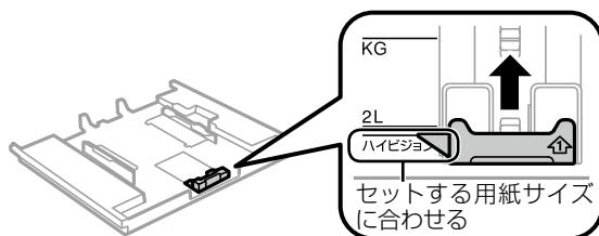
6 印刷する面を下にして、手前の用紙ガイドに合わせてセットします。
