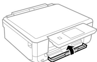
**5** プリンターの底面に収納されているディスクトレイを取り出します。
