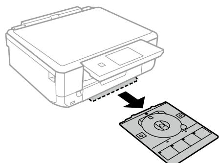
**6** 印刷する面を上にして、ディスクトレイにディスクを載せます。ディスクの中央付近を押さえてセットしてください。
