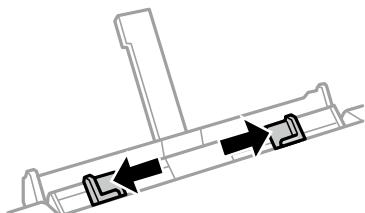
印刷する面を手前にして、用紙の先端を約 5cm 差し込みます。
