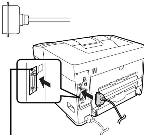
パラレルケーブルのアース線は、インターフェイスブラケットのネジに接続してください。
