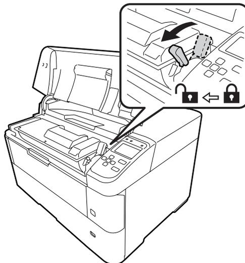
4 カートリッジの右側を持ち上げるようにして取り外します。
