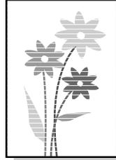
**ノズルチェック** : ノズルの状態を確認するためにパターンを印刷し、そのパターンを見てノズルが目詰まりしていないかを確認します。
