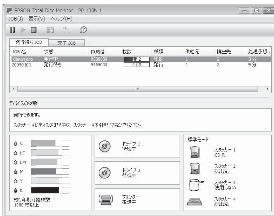
[発行待ち JOB] 画面：「発行待ち」、「発行中」、「一時停止中」、「一時停止処理中」、「キャンセル処理中」、「復帰待ち」、「復帰待ち処理中」状態の JOB の一覧が表示されます。
