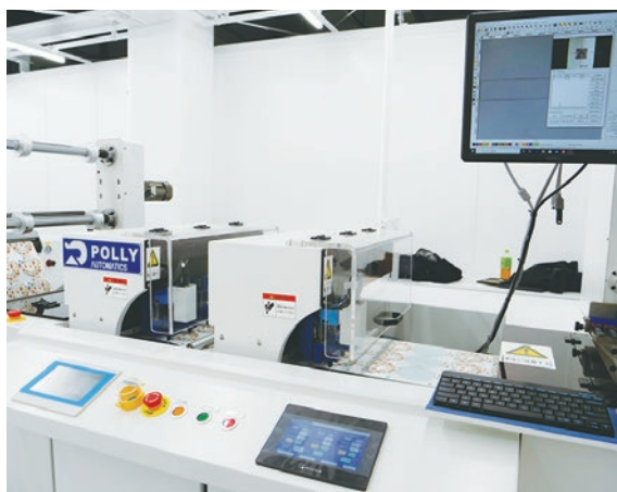
国内累計100台以上の導入を誇る水性IJ方式「SurePress L-4733AW」。課題の後加工も高速カッティングプロッターの接続で解決
