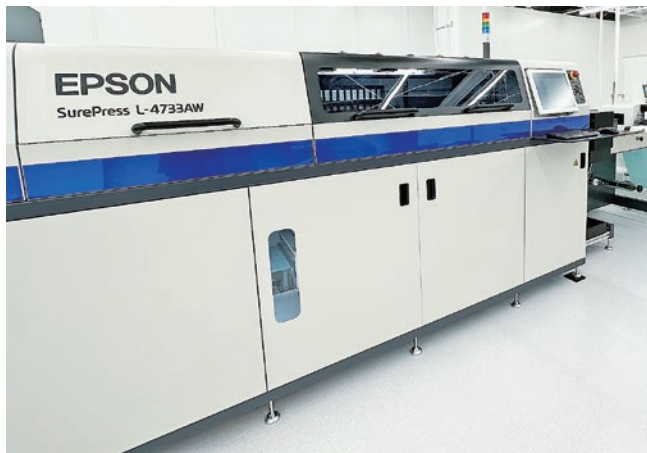
国内累計100台以上の導入を誇る水性IJ方式「SurePress L-4733AW」。課題の後加工も高速カッティングプロッターの接続で解決
