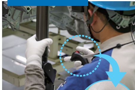
PCで行っていた操作はワイヤレスマウスを使って、遠隔操作が可能に。1ステップごとにPCを見に戻っていたという、無駄な移動時間が大幅に削減された
