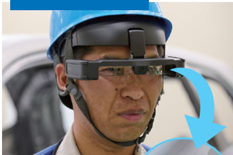
スマートグラスに、PC画面に映し出されている3Dモデルと測定データが大きく目の前に現れる (注) 右はPCの画面
