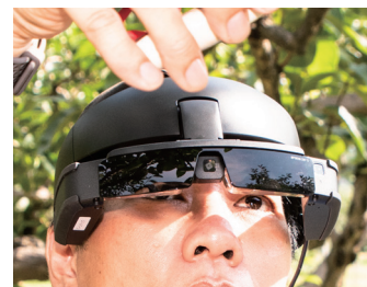
約800万画素のカメラが、スマートグラスの中心部に配置。本体側面に搭載するモデルに比べ、本機装着者の視野とのずれが少ない。
