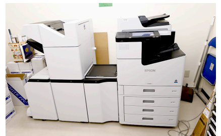
事務室の印刷室に設置されたLX-10050M中綴じフィニッシャー付、高速印刷で冊子制作などにも活用
