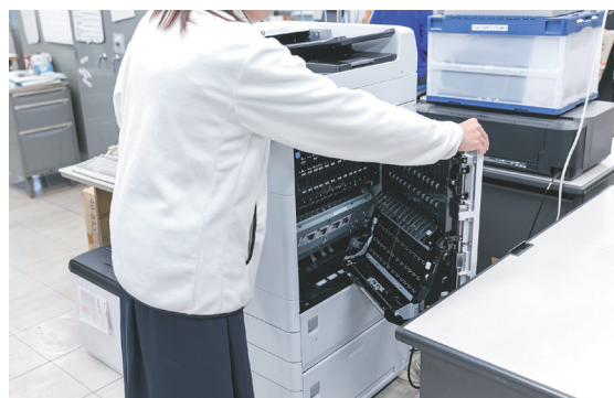
万が一紙詰まりしても、パネル画面で詰まった箇所を知らせてくれて、用紙にもアクセスしやすい構造になっているので除去も簡単。
