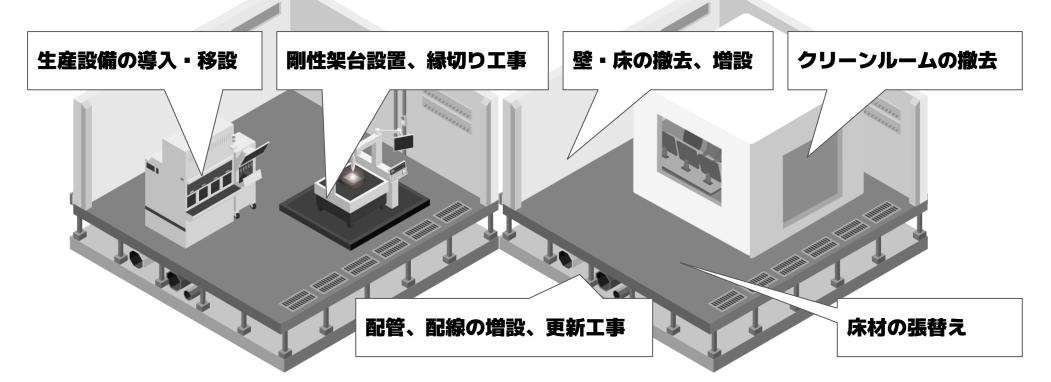
改修工事と一口にいっても、その目的や規模、工事内容は多様です。設備の老朽化による入れ替え工事、工場施設の目的変更に伴う構造変更、精密機器導入のための補強工事、床材・壁面のリニューアル修繕工事等多岐にわたります。 また、工事規模も1日で完了できる軽微なものから、数カ月、数年といった大規模なものまで、工場施設の規模や工事内容によって様々です。
