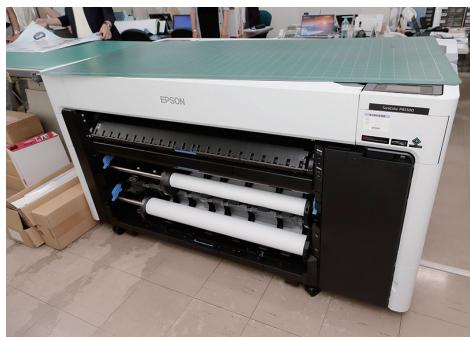
ダブルロールモデル採用により、用紙の交換頻度を軽減。
