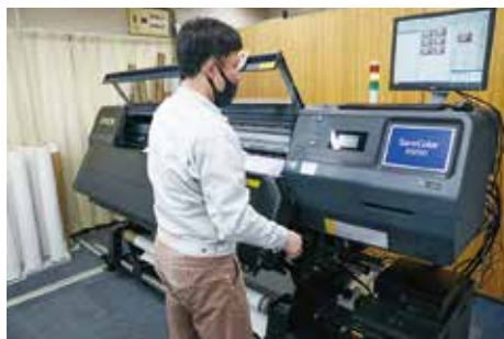
用紙交換作業も無理なく一人で行うことができ、タッチパネルで簡単にセッティングが完了できる。
