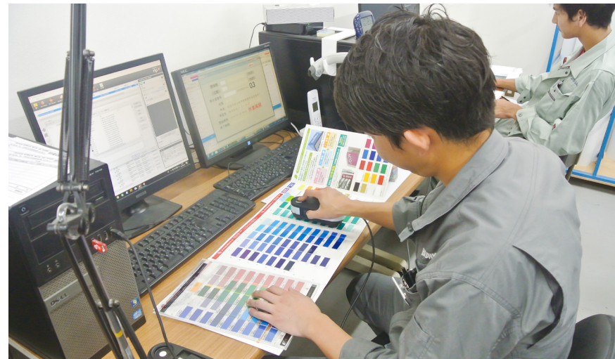
測色器を導入したことにより、これまで1～2時間掛かっていた色合わせの作業が、半分程度にまで短縮できたという。
