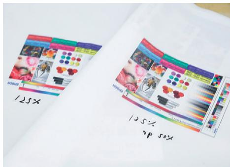
新たな素材への印刷では、用紙の許容度やインクの定着性、鮮明さや発色なども違うため、テスト印刷で最適条件を探る。
