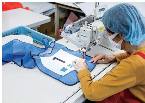
ターイボリン素材に「SC-R5050」で印刷したゼッケン部品を工業用ミシンでネット地に縫い付けて安全ベストとして完成。
