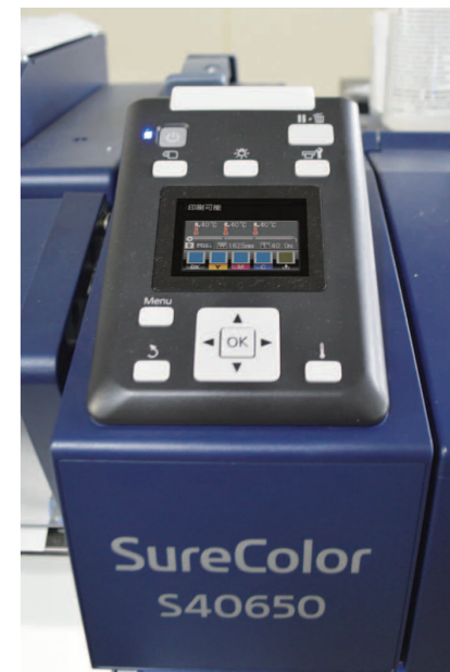
日常的に行う操作を本体前面右側に集約したフロントオペレーションを実現。コントロールパネルには、カラーLCDを採用しインク残量が一目で分かるなど、業務効率アップに貢献する。
