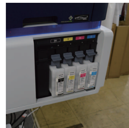
大容量700mlインクカートリッジが採用されており、連続稼働も可能にする。大量印刷や長尺印刷、夜間運転などでもダウンタイムを最小限にする。
