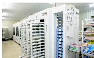
患者さん1施用ごとに注射薬が払い出される注射薬自動払出しシステム
