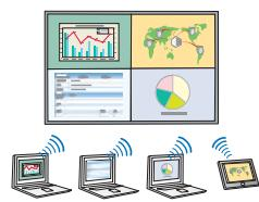
PC・スマートフォン・タブレットは最大50台までネットワーク接続が可能。そのうち最大4台の画面をプロジェクターから分割投写できる。
