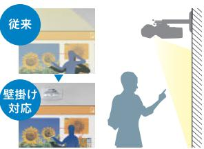
超短焦点で壁掛け設置ができるため、設置スペースが不要。壁掛け設置では、ほぼ真上から投写するため投写面近くに人が立っても影ができにくく、画面が見やすい。
