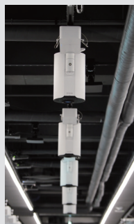
導線に沿って天井に11台のEV-100を配置。同じく天井に配置された人感センサーと連動するようにしている(写真・左)。右壁面のパネルを操作することで道案内が開始。人が矢印を通過すると矢印が消える(同・右)。
