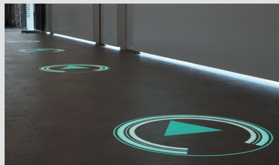
EV-100によって床面に投写された、道案内の矢印。案内が開始されると施設までの矢印が表示され、人感センサーが人の通過を確認することで、矢印が順に消えて行くようになっている。表示は十分に明るく、各矢印がアニメーションになっているので進むべき方向も素早く判断できる。学生たちがセンサーの動作や位置、映像の動きなどを熱心にチェックする様子が印象的であった。
