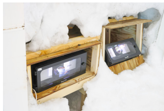
木枠を広めにして排熱ができるように工夫し、雪の壁面に埋入。投写面までの距離を長くでき、少ない台数でドーム全体に映像を投写できた。
