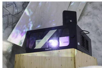
かまぼこ型ドームの前後となる直立した壁面用の機材。ハウジングを使用し台の上に設置した。合計9台（予備1台）で床以外の全面に投写。
