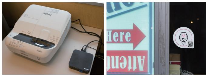
サーバへの接続は、セットトップボックスを介して、無線LAN経由で接続している。セットトップボックスとEB-685Wは、(注)HDMI®ケーブルで接続している。
