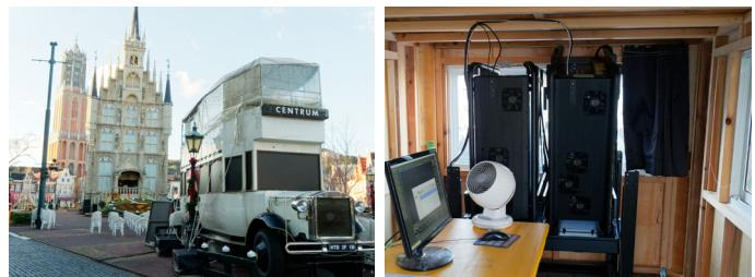
プロジェクターは、お客様に違和感を与えないように広場に配置したバスの2階に設置され、映像はバス後部の窓越しに投写(写真・左)。設置場所には、縦置きのプロジェクター2台と制御用のパソコンがあり、時間になると自動で投写される。2021年春に従来の機材から更新され、夏以降は本格運用されている(写真・右)。
