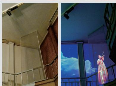
左の写真のように中二階の一部に透過型スクリーンを配し、天井にEV-105を設置。右の写真のように透過型スクリーンに人物の映像を投写することで、立体感のある映像演出を可能にした。
