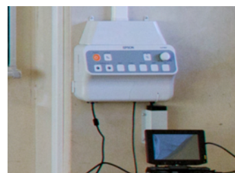
EB-455WT とパソコンは インターフェイスボックス (ELPCB01) で接続
