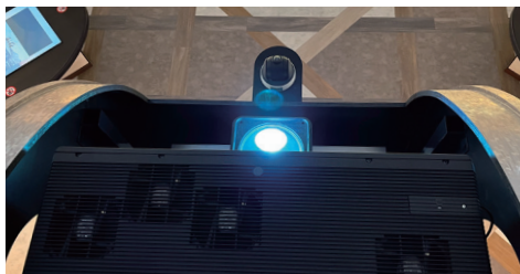
EB-L30000UIに装着された超短焦点レンズの様子。構造上、振動を拾いやすいが、しっかり固定され映像に影響することはない。
