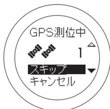
GPS 測位が完了すると、測位完了画面が点滅した後、計測画面になります。
