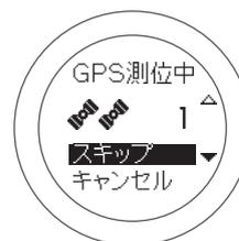
計測中に GPS 測位は継続され、測位が完了すると位置情報が記録され始めます。なお、GPS 測位が完了するまではインドアモードと同じく移動ルートなどは記録されません。
