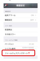
(3) 画面の指示に従って、機器をクレードルにセットし充電状態にします。 スタートボタンを押すとファームアップデートが開始されます。
