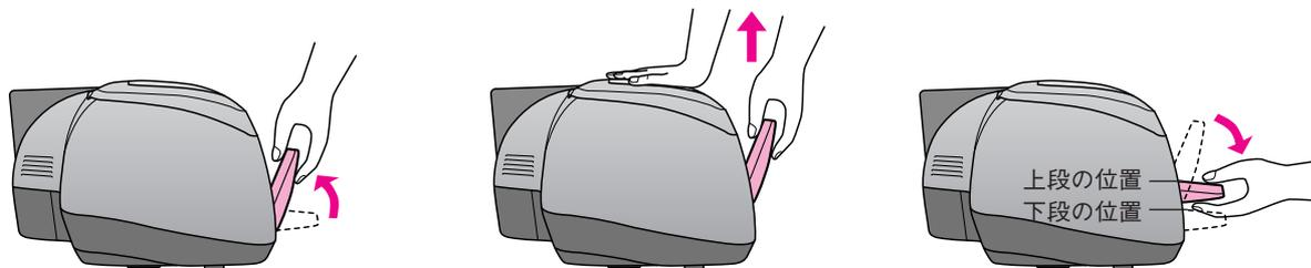
※上段から下段にする場合は、上記と逆の手順で排紙トレイを斜めにし、押し下げてから手前に倒します。
