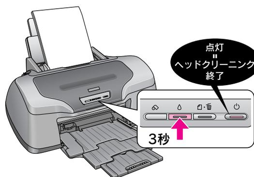
2 ヘッドクリーニング後は、再度ノズルチェックを行って、ノズルの目詰まりが解消されたかをご確認ください。
