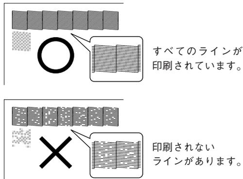
クリーニング後は画面の指示に従って、再度ノズルチェックパターンを印刷し、目詰まりが解消されたかをご確認ください。
