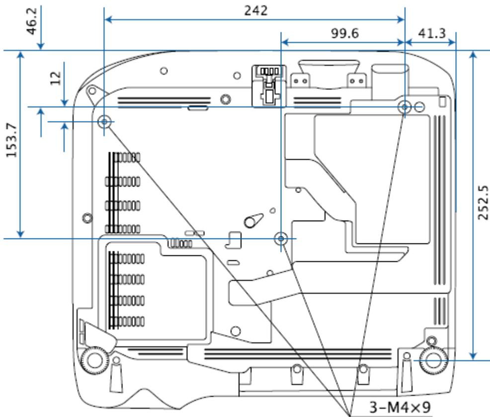
■天吊り金具(ELPMB23)装着図 EB-2142W
