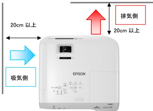
프로젝ターを箱などに入れて、排気口から出た暖かい排気が吸気口へ回り込むような設置はしないでください。
