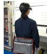
ドラフトチャンバー（局所排気装置）を使用の場合など、危険を伴う場合はスマートグラスを着けた状態で面体も使用。映像はチャンバーのガラスと面体を通した状態だが、ボケたりブレたりすることはない（写真・左）。ノートPCにはショルダーバッグに入れて装備（写真・右）。
