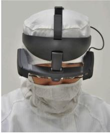
BT-45Cでの動画撮影は、撮影される映像をスマートグラス上で確認しながら作業できる。実視野の中に撮影中の映像が見えていため、撮影ミスが起きにくい。
