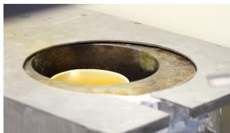
実際に行う作業の例として、IC（集積回路）の樹脂パッケージを溶液で溶解し、開封する作業を実演していただいた。ICを溶液の入ったつぼに入れ（上の写真）、加熱して溶解する（右上の写真）という作業だが、煙の色の変化度合いなど、映像で見ないと分かりづらい。これらをスマートグラスを装着して作業するだけで、作業者一人の作業で映像素材化できるのも利点とのこと（右の写真）。
