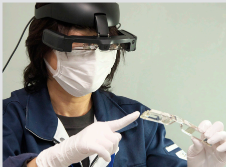
BT-45Cを用い、異なる事業所間で分析すべき位置を確認する様子。PCのポインターを用いて指示(写真:右)した位置を、作業者が指差して確認(写真:左)している。
