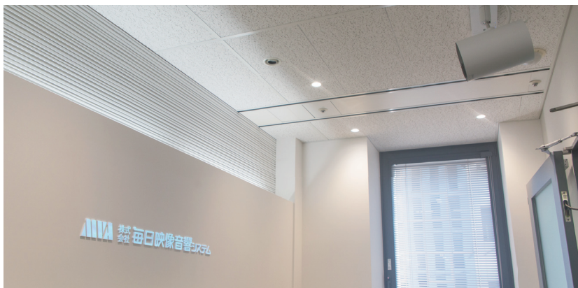
本社入口すぐの壁面にある毎日映像音響システムのロゴ。壁面と同色の白いロゴに対してプロジェクションマッピングを行うことで、ロゴが浮かび上がって見える。
