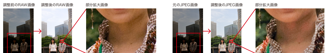
逆光により暗くつぶれてしまった人物や木々の表情を復元してみる。RAWの場合、やや極端な調整を行っても滑らかな階調で本来の色に復元してくれるが、JPEGでは階調や色調を調整しても限界がある。調整後のJPEG画像を拡大してみると、日陰になった人物の肌や背景の手すり部分に、好ましくない色のにじみが発生している。
